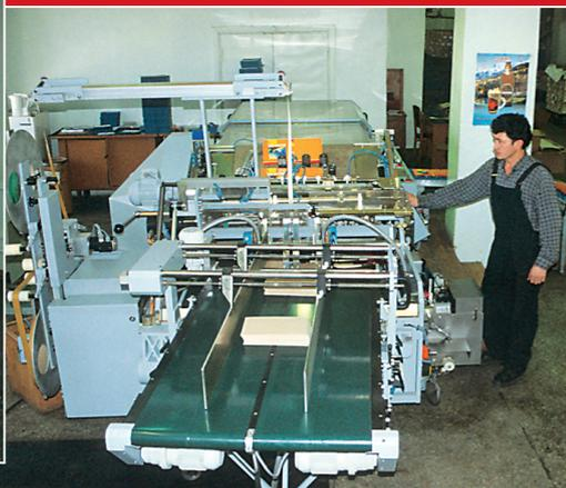
Изготовление крышек осуществляется на высокоточной крышкоделательной машине BDM-60 Hörauf и интегральные крышки на машине "Petratto" итальянского производства. При необходимости производится тиснение фольгой на позолотном прессе KOLBUS. Изготовление брошюр бесшвейным способом осуществляется на одной из лучших машин своего класса Amigo — фирмы Müller Martini. Изготовление брошюр вкладкой производится на вкладочно-швейно-резальном агрегате модель 735 (Германия).
